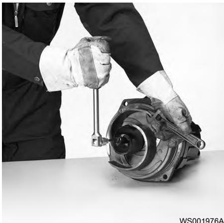
3. Снимите рабочее колесо.
